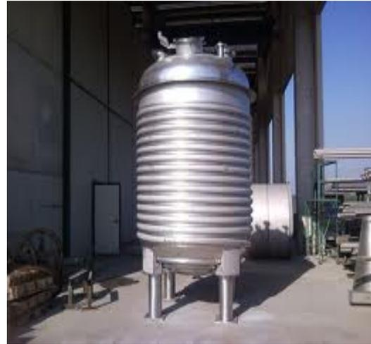
Il nostro *secondo reattore* è la metà del primo (10 tonnellate) ma non meno fondamentale, qui, il composto del primo reattore viene trattato con acqua e quindi abbiamo la precipitazione delle scaglie, di seguito, ma sempre nello stesso reattore, le trattiamo con candeggina, per decolorarle.
